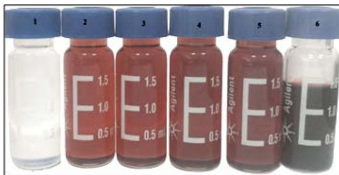
Рис. 1. Приготовленные растворы в бензольном растворителе: 1 – ПС/бензол; 2 – ПС/ C_{70} /бензол ( C_{70} \sim 4,17\% ); 3 – ПС/ C_{70} /бензол ( C_{70} \sim 8,34\% ); 4 – ПС/ C_{70} /бензол ( C_{70} \sim 12,51\% ); 5 – ПС/ C_{70} /бензол ( C_{70} \sim 16,68\% ); 6 – C_{70} /бензольный раствор.
