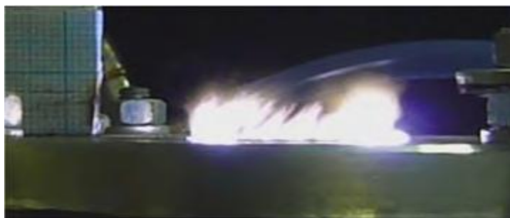
Вид сбоку. Поток воздуха 80 л/мин. Ток I = 300 mA, напряжение U = 600 V. Глубина погружения центрального электрода l = 0 mm
