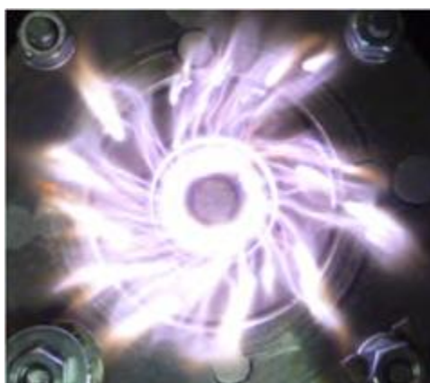
Вид сверху. Поток воздуха G = 80 л/мин. Ток I = 320 мА, напряжение U = 1100 В. Глубина погружения центрального электрода l = 9 мм
